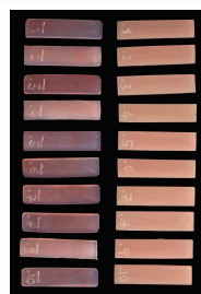
Abb. 6: Polyamid-12 und PMMA nach Test auf Farbbeständigkeit
